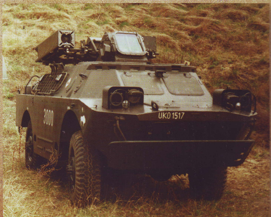
★ Боевая машина 9А31 Войска Польского. Пусковая установка сложена в походное положение.
