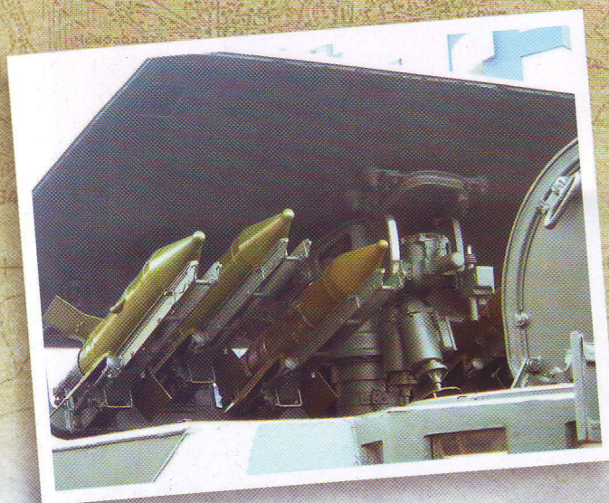
★ Вид крупным планом на пакет направляющих и ПТУР 9М14М «Малютка-М».
